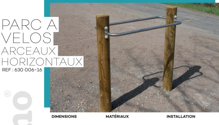
Longueur : 1080 mm Largeur : 430 mm Hauteur : 1000 mm Pin classe 4 Barres inox Fixation par scellement des appuis bois
